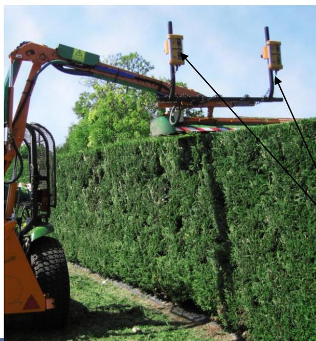
Dispositif de guidage laser
