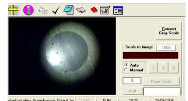
Fig. Mesure de l'empreinte laissée par une bille polie
