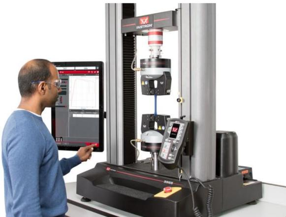
Fig. Essai de traction sur machine Instron 5965
