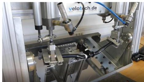
Fig. Bancs d'essai de test de fatigue de sièges (ferroviaire) et guidon de VTT
