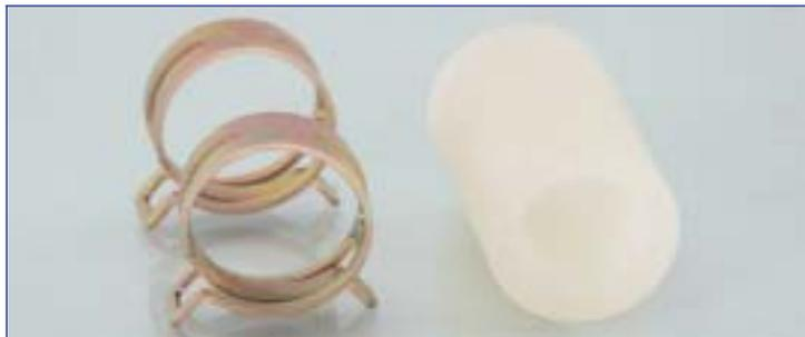
Durit de raccordement pour résonateur
