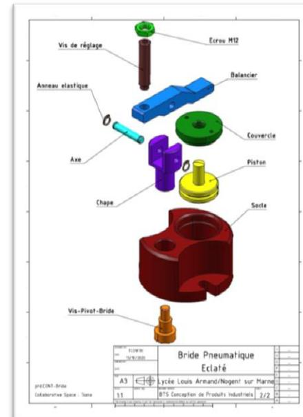
Fig. Mise en plan de l'éclaté
