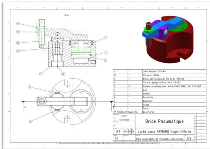
Fig. Mise en plan de l'ensemble avec nomenclature
