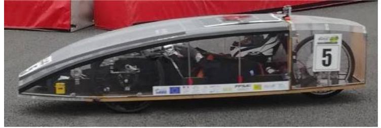
Le véhicule à trois roues, embarque une motorisation électrique-transmission qui entraîne la roue arrière (propulsion).
