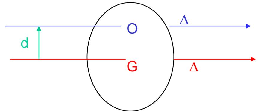
Un moment d'inertie par rapport à un axe (ou à un plan) est toujours minimum lorsque cet axe (ou ce plan) passe par le centre de gravité du solide.
