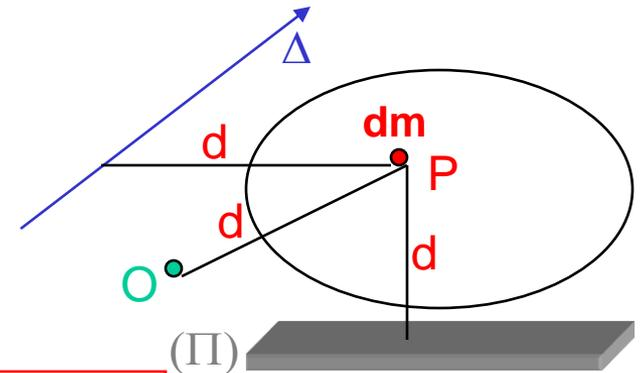
Le **produit d'inertie** caractérise l'absence de symétrie de la répartition des masses autour des 3 axes d'un repère lié à un solide. Les produits d'inertie créent des effets de balourd perpendiculaires à l'axe autour duquel tourne le solide.
