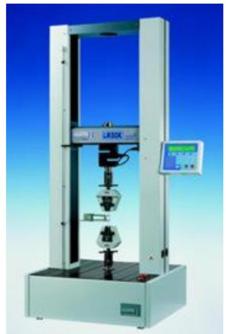
L'éprouvette va se déformer progressivement puis rompre.
