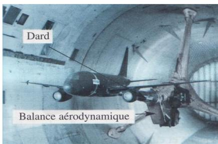
La maquette est maintenue en position dans la veine d'étude de la soufflerie à l'aide d'un « dard », lui-même relié à une « balance aérodynamique » qui mesure l'intensité des différentes actions aérodynamiques qui s'exercent sur la maquette.
